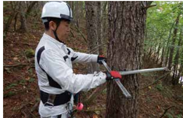
輪尺を用いた胸高直径の測定
