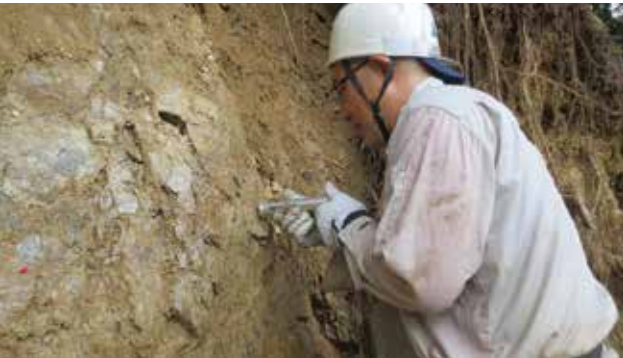
土壌硬度計による調査
